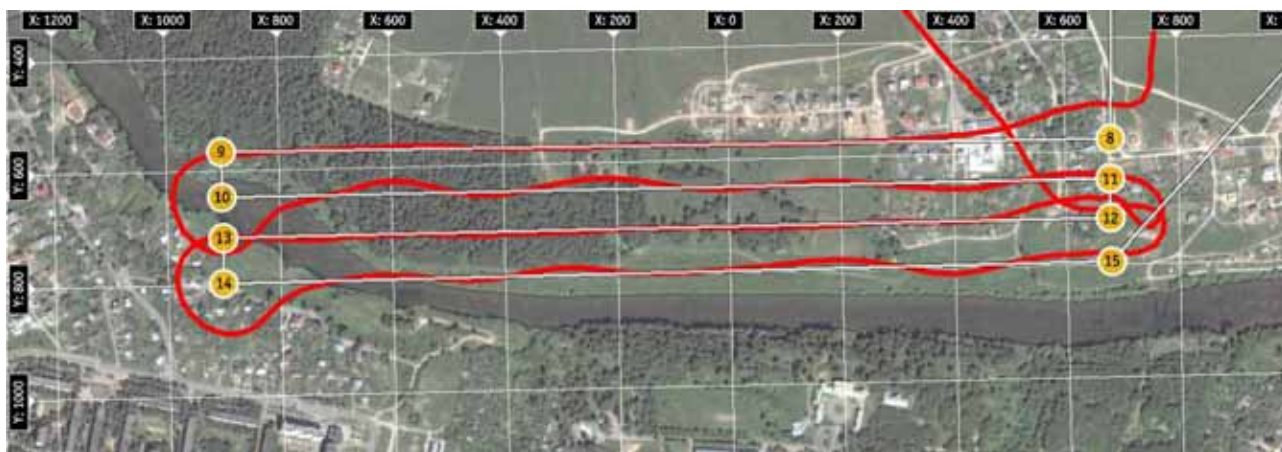
Рисунок 5: Маршрут и траектория полета мини БЛА при съемке местности
